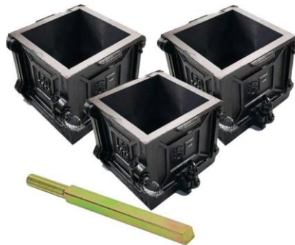
รูปที่3.6 แบบหล่อคอนกรีต 3.2.3 เครื่องทดสอบแรงอัดของคอนกรีต ดังรูปที่3.7
