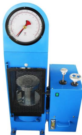
รูปที่3.7 เครื่องทดสอบแรงอัดของคอนกรีต
